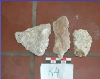
K4 Κονίαμα γύρω από οριζόντια ξύλεια εντός σώματος βάθρου
