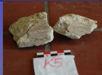
K5 Κονίαμα γύρω από ξυλεία εσχάρας τόξου
