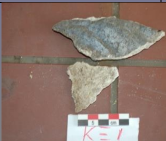
K4 Κονίαμα γύρω από οριζόντια ξύλεια εντός σώματος βάθρου
